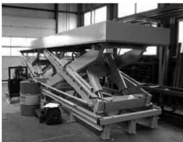
Hình 3. Nguyên lý hoạt động và kết cấu của cầu nâng tải trọng 20 tấn, kích thước sàn nâng 10x1,7m, chiều cao nâng 2,4m [4]
