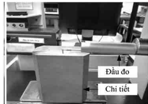
Hình 3. Thiết bị đo độ nhám bề mặt SV – C3200
