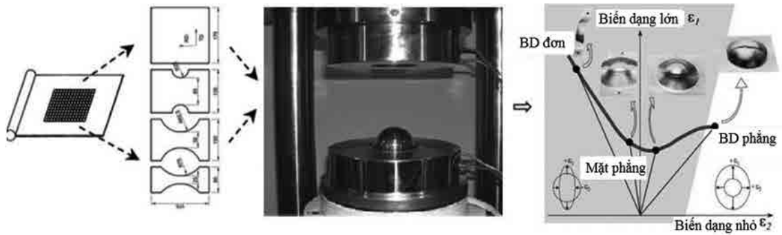
Hình 5. Sơ đồ thí nghiệm FLD
