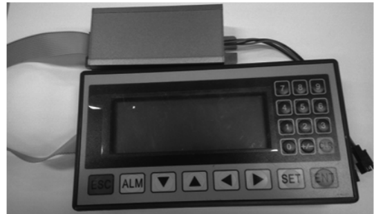
Hình 7. Bộ điều khiển cường độ sáng giàn đèn nuôi cấy mô
