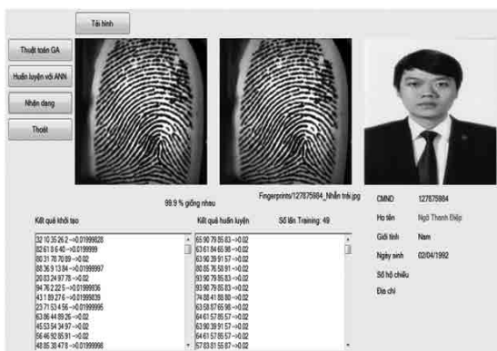
Hình 8. Nhận mẫu vân tay bằng mạng nơ ron với GA
