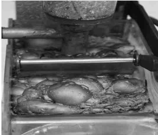
Hình 5. Bọt than nổi lên trong quá trình tuyển nổi
