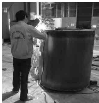
Hình 3. Chế tạo mẫu lò khí hóa sinh khối “ấm” sử dụng cho lõi ngô tươi sau tẽ hạt
