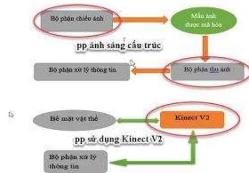
Hình 3. Sơ đồ phương pháp ánh sáng cấu trúc và phương pháp sử dụng Kinect
