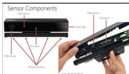
Hình 4. Cấu tạo của cảm biến Kinect V2
