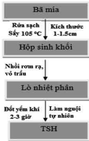
Hình 3. Quy trình chế tạo TSH từ bã mía
