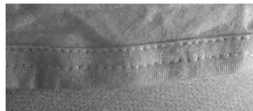
Hình 4. Đường may với mật độ 4 mũi/1cm
