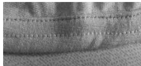
Hình 5. Đường may với mật độ 5 mũi/1cm
