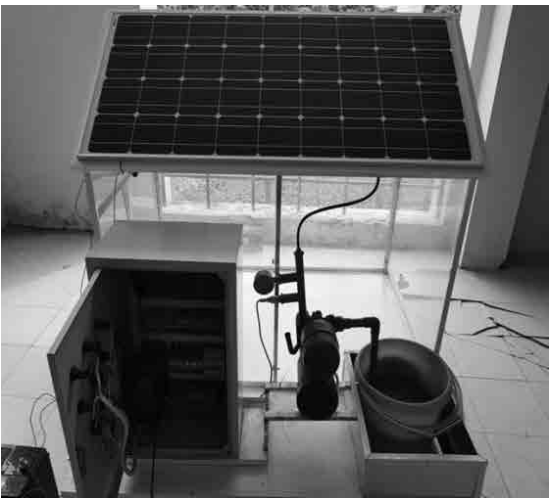
Hình 5. Mô hình thực tế hệ thống phun sương làm mát tự động sử dụng nguồn năng lượng mặt trời
